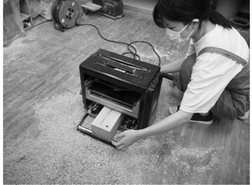
写真7 自動鉋盤で製材を行う
