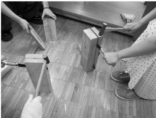
写真6 鉋を使って角材を割る
